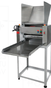
Cilindro laminadora para masas, 510mm de ancho Capacidad de 8kg CLMC220M60S51 0.77 X 0.96 X 1.71 Estructura soportante
