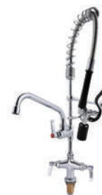
Mini llave de prelavado a piso mezcladora con car- tuchos de cerámica spray standard tubo, resorte y bracket de pared, NSF marca Bonne. MCGS192006
